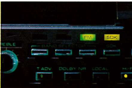
Tutti i tasti sono illuminati da una tenue luce blu collegabile, per l'accensione automatica, all'impianto principale di illuminazione della vettura.
